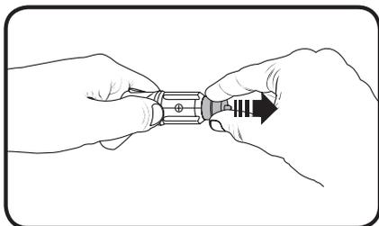
**IT SOSTITUZIONE DEL FUSIBILE
