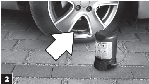
2 Avvitare il raccordo del tubo proveniente dal serbatoio del sigillante alla valvola dello pneumatico
