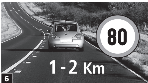
6 Scollegare il tubo dalla valvola dello pneumatico e partire immediatamente. Guidare per almeno 1 o 2 Km per far sì che il sigillante venga distribuito uniformemente all'interno dello pneumatico. Fermarsi e controllare che il foro sia stato ostruito dal sigillante e che non vi siano uscite d'aria. Se durante il processo di sigillatura del foro lo pneumatico ha perso leggermente pressione, è possibile ripristinare la pressione desiderata tramite il compressore
